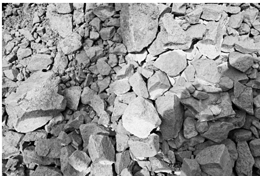
写真－16 立坑部掘削岩片（花崗岩）
