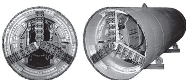
写真-1 開放型セミシールド掘進機の1号機
