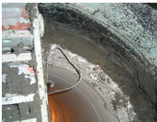
CMT 式既設管破碎改築工法の工場実験
