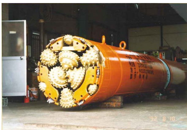
岐阜県土岐市で採用された 硬岩用複合掘進機
