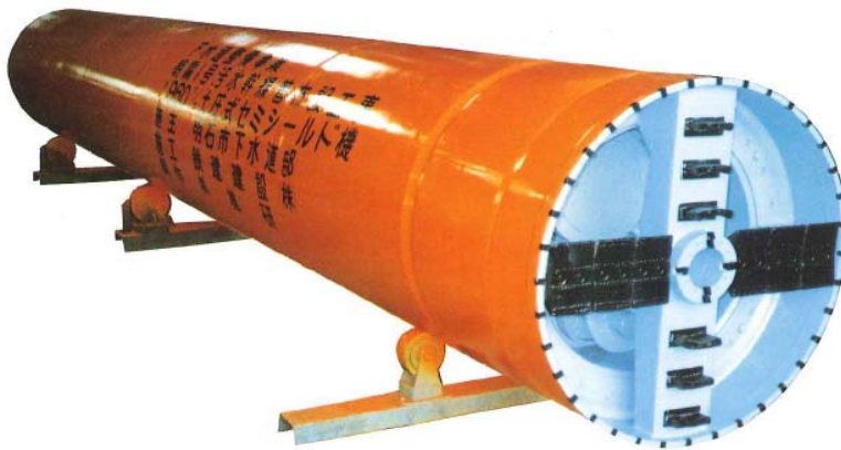
明石市で採用された土圧送型掘進機
