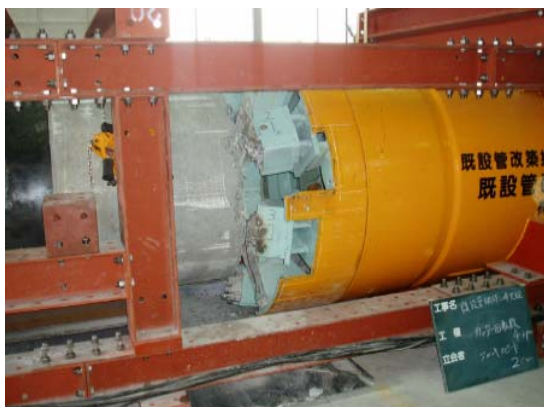
CMT 式既設管破碎改築工法の工場実験
